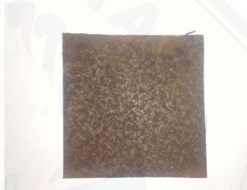
Sebelum proses sand blasting
