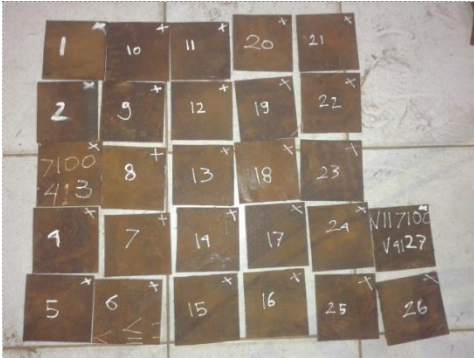
Spesimen yang sudah dipotong dengan dimensi 100 mm x 100 mm x 5 mm
