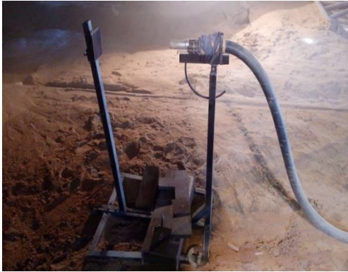
Pengaturan sudut penyemprotan 90°
