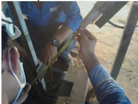
Pengaturan jarak & sudut penyemprotan 30°
