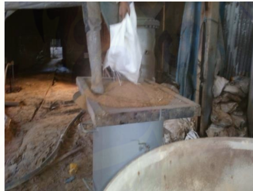
Memasukkan pasir silika ke dalam sandpot
