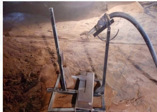
Pengaturan sudut penyemprotan 60°
