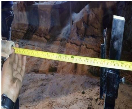
Pengukuran jarak penyemprotan dari nozzle ke spesimen
