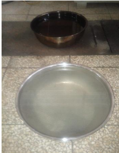
D. Media quenching oli SAE 5W (atas) dan air garam (bawah)
