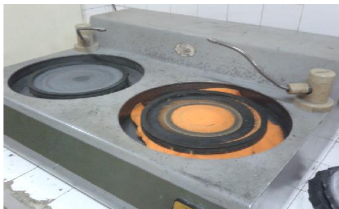
F. Mesin penghalus untuk menghaluskan permukaan spesimen
