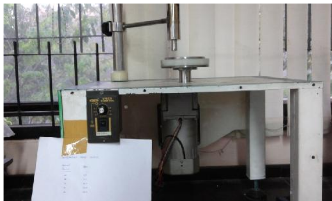
I. Tribometer Pin On Disc untuk menguji keausan
