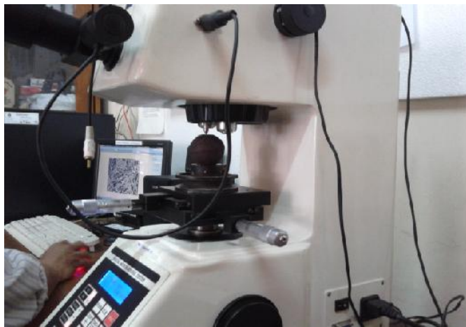
H. Pengujian kekerasan dengan Micro Vickers Hardness tester
