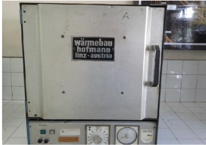
A. Dapur listrik ( furnace ) untuk pemanasan grinding ball
