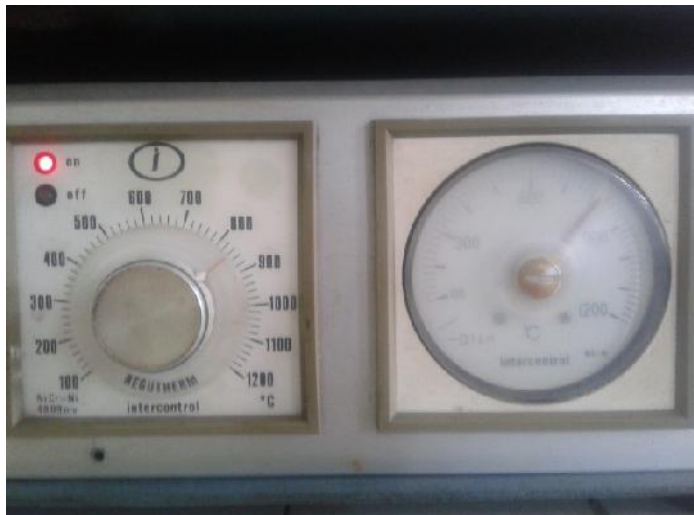
B. Pemanasan grinding ball hingga suhu 850 0 dan ditahan hingga 2 jam
