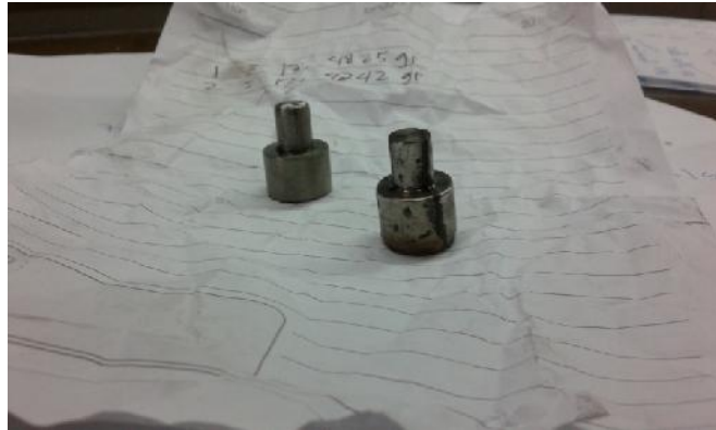
J. Bentuk spesimen pin grinding ball untuk pengujian aus
