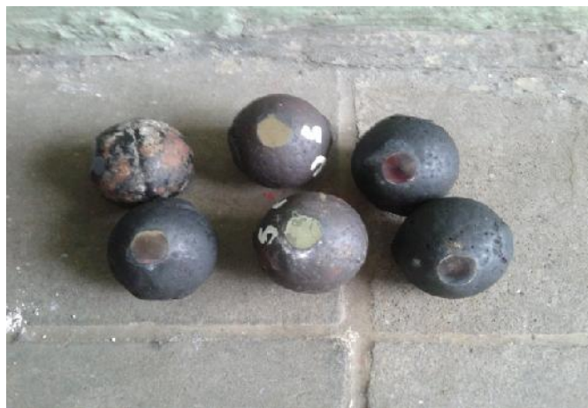
E. Grinding ball sebelum dan setelah di- quenching
