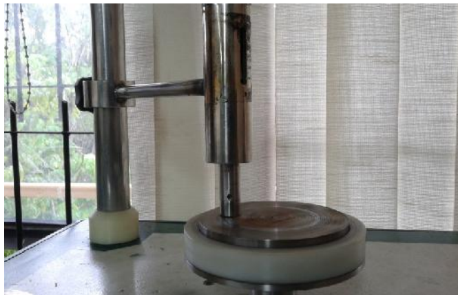
K. Pengujian aus pada grinding ball
