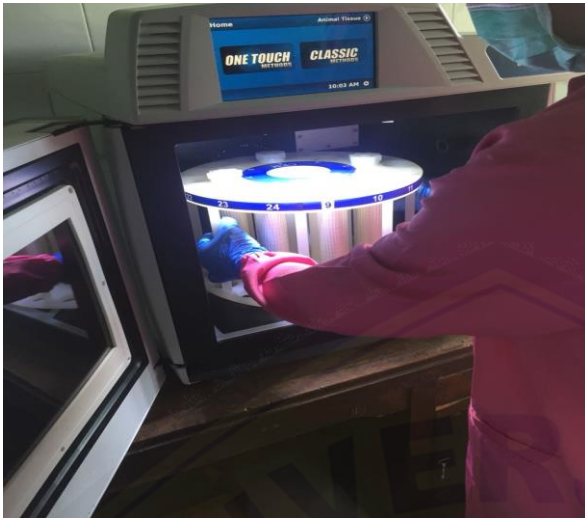
Gambar 13. Preparasi sampel menggunakan microwave digester
