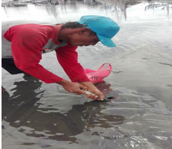
Gambar 5. Pengambilan sampel sedimen pada saat surut
