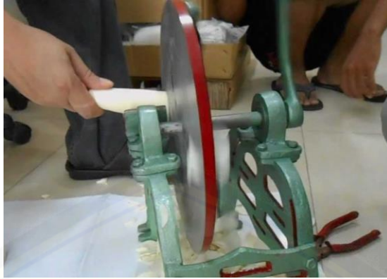
Gambar 2.4 Mesin Perajang Umbi Manual (Sumber : M.Sajuli dan Ibnu Hajar, 2017)
