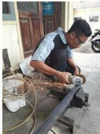
Gambar C.2 Pemotongan Bahan (ST-37)
