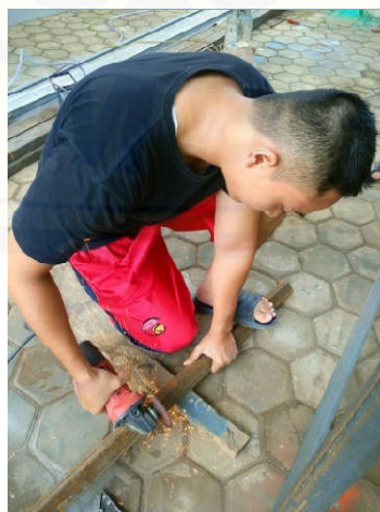
Gambar C.11 Proses Pemotongan Besi Profil L Sebagai Rangka
