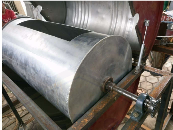
Gambar C.21 Proses Pemasangan Tabung Silinder
