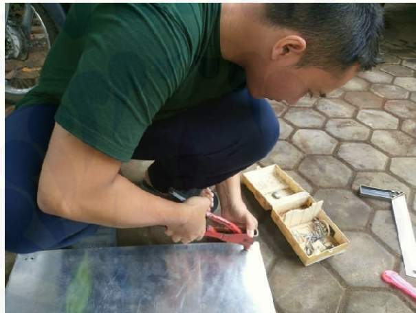
Gambar C.25 Proses Pemasangan Clamp Pengunci pada Tutup Tabung
