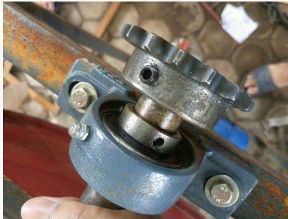
Gambar C.16 Proses Pemasangan Bearing dan Poros
