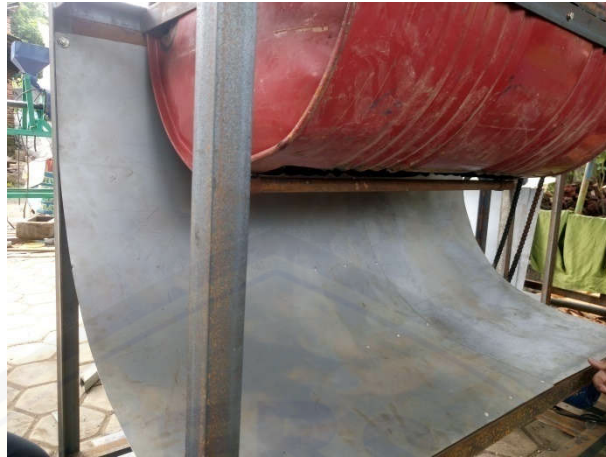
Gambar C.30 Proses Pemasangan Slider
