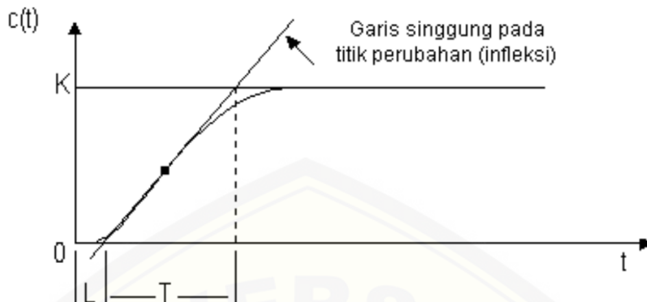
Gambar 2.15 Proses Desain Penentuan Parameter L dan T
