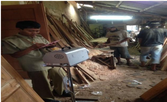
Pengukuran Kadar Debu di Lingkungan Kerja Menggunakan HVDS
