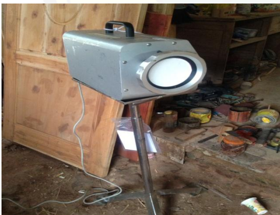
Alat HVDS yang Digunakan Untuk Mengukur Kadar Debu di Lingkungan Kerja
