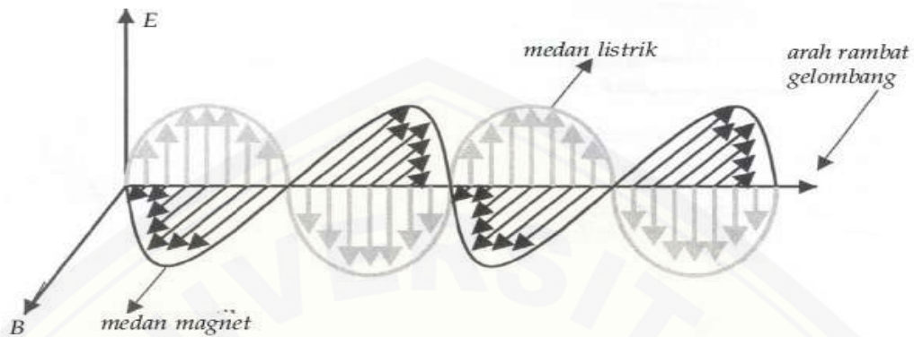
Gambar 2.2 Perambatan gelombang elektromagnetik yang tegak lurus arah medan listrik dan magnet
