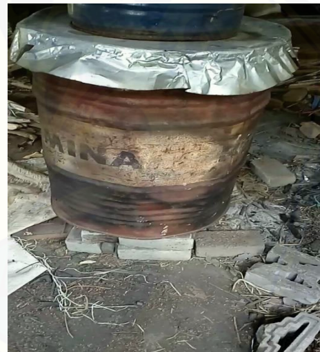
Gambar 5. Menutup rapat, sehingga diusahakan tidak ada oksigen (pirolisis sederhana).
