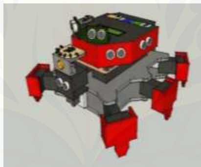
Gambar 3.1 Mekanik robot pemadam api berkaki
