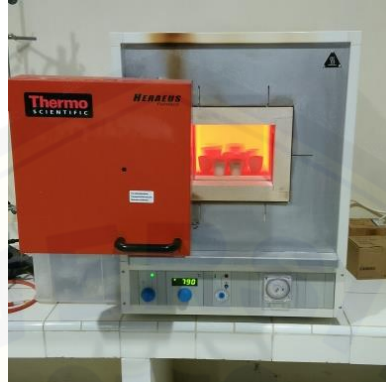
Gambar 3.2 Proses pembakaran dengan furnace (koleksi pribadi)
