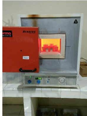
Gambar 3.11 Proses pengeringan dengan furnace (koleksi pribadi)
