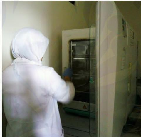
Gambar 3.10 Menyimpan 96-well mikroplate yang berisi sel ke dalam incubator CO<sub>2</sub> dengan suhu 37°C (sumber: dokumen pribadi)
