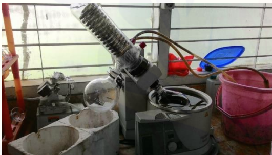
Gambar 3. Proses pemisahan pelarut untuk mendapatkan ekstrak biji bintaro
