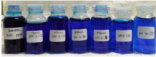
(a) Larutan metilen biru tunggal setelah adsorpsi pada variasi pH sistem
