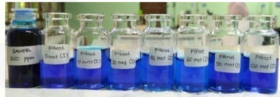
(d) Campuran larutan metilen biru-Pb setelah adsorpsi pada variasi waktu kontak
