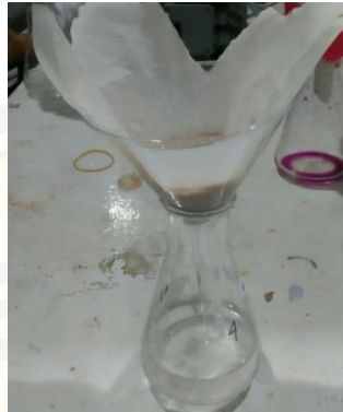
Gambar 3.7 menyaring abu ampas tebu dengan kertas saring whatman (koleksi pribadi, 2018)
