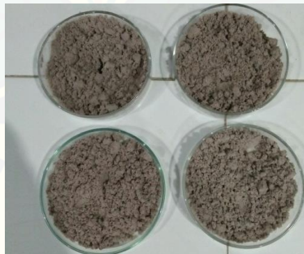
Gambar 3.9 pengeringan natrium silikat tahap akhir dengan alat furnace (koleksi pribadi, 2018)
