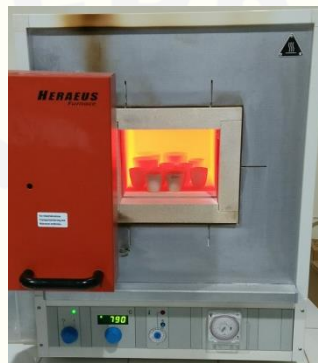
Gambar 3.5 Pembakaran abu dalam alat furnace bersuhu 900^{\circ}\text{C} (koleksi pribadi, 2018)
