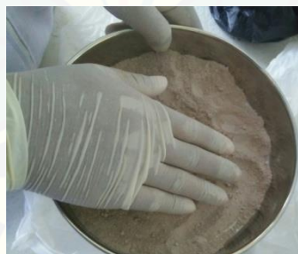
Gambar 3.6 mengayak abu ampas tebu dengan ayakan mesh (koleksi pribadi, 2018)
