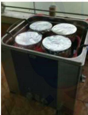
Proses maserasi dengan ultrasonik
