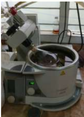
Proses menguapkan dengan rotary evaporator
