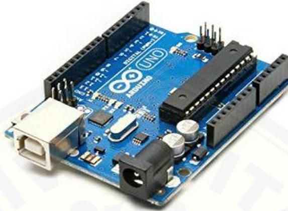
Gambar 2.4 Arduino uno ATmega328P
