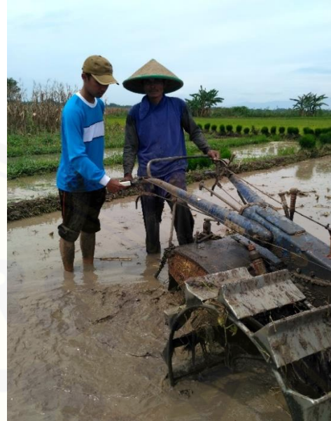
Gambar 10. Pengukuran getaran pada kemudi
