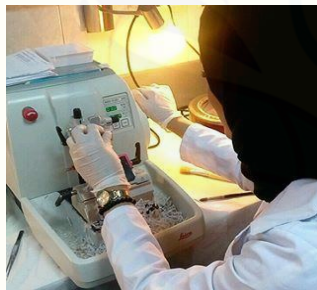
Proses memotong parafin menggunakan mikrotom
