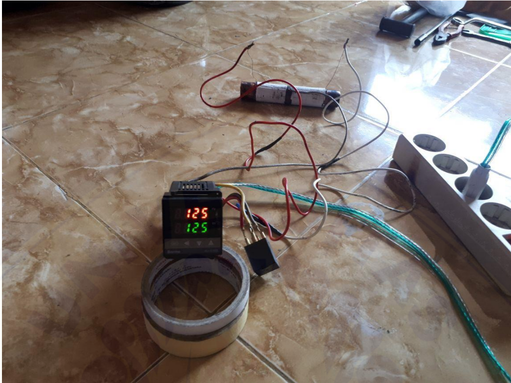
Gambar F.2 Termokontrol Dengan Variasi Kontrol Suhu 125 °C
