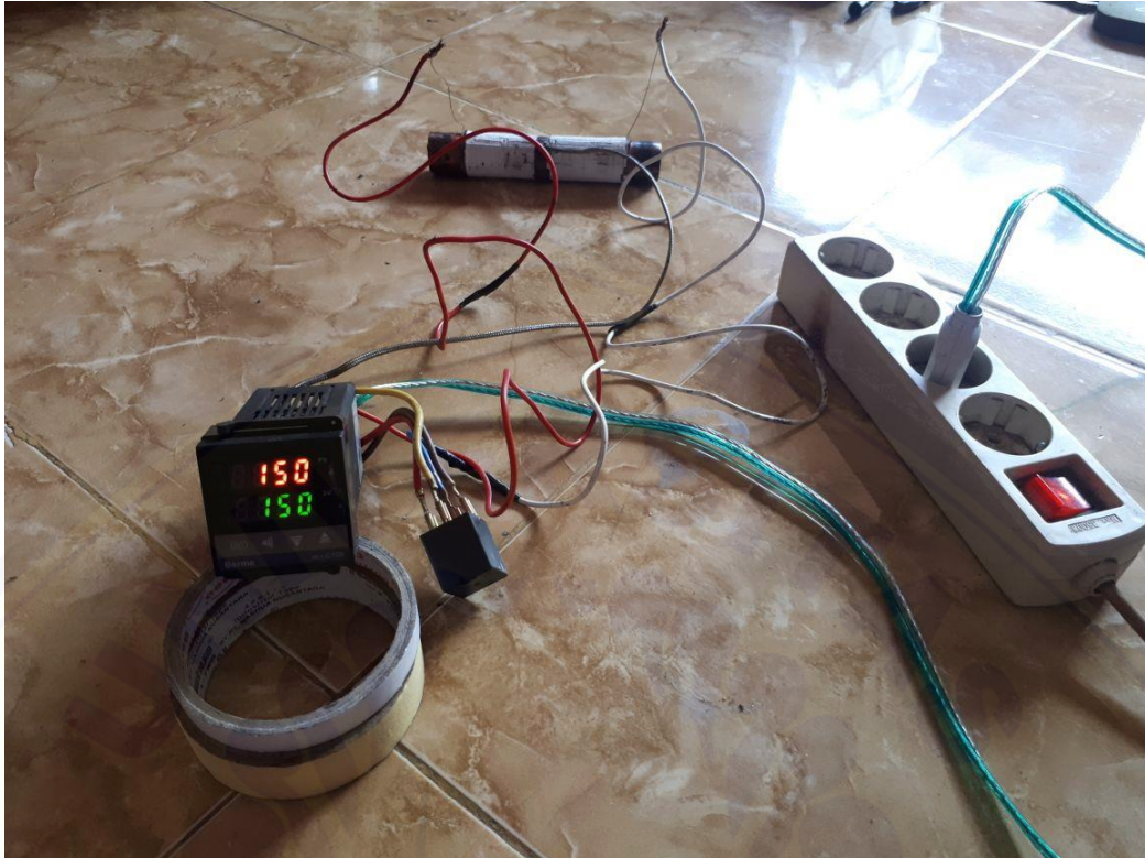
Gambar F.3 Termokontrol Dengan Variasi Kontrol Suhu 150 °C
