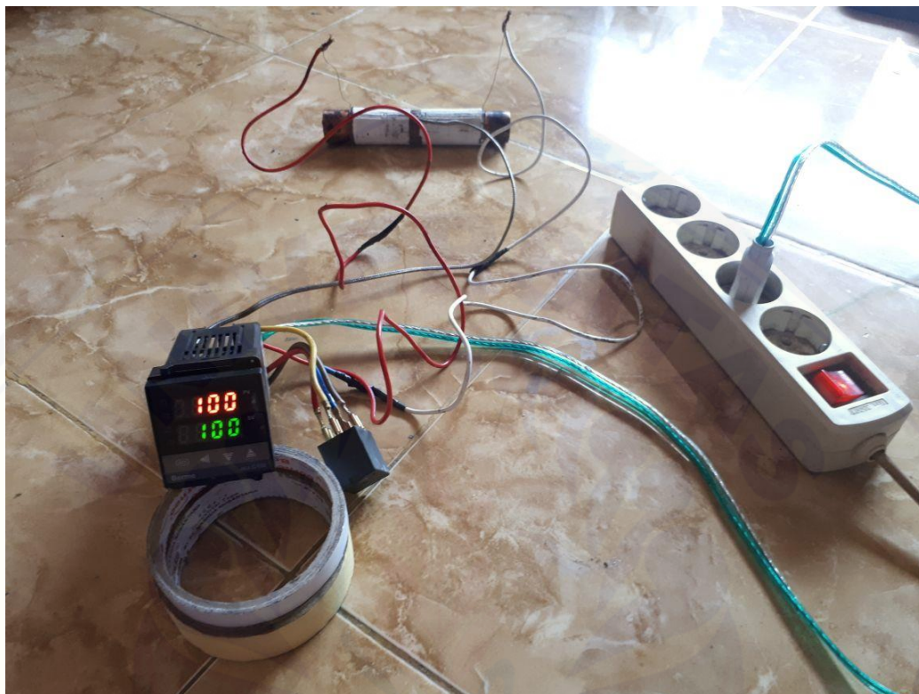
Gambar F.1 Termokontrol Dengan Variasi Kontrol Suhu 100 °C
