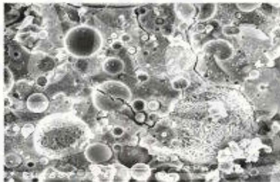
Gambar 2.10 *Scanning Electron Microscopy* dari Campuran antara Abu terbang dengan Natrium Silikat (Kosnatha dan Utomo dalam Hutajulu, 2007)
