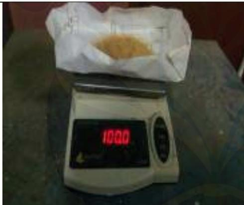
Pengujian Bahan: uji kadar resapan pasir ottawa.
