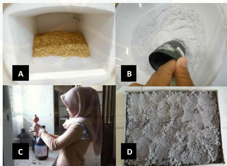
Gambar 2.2 Pengabuan sekam padi di Furnace (A), Penumbukan abu agar menjadi Nanosilika (B), Pemipetan HCL (C), Abu yang telah dimurnikan dengan HCL (D).
