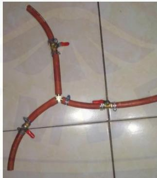
Gambar 3.1 Gambar alat pencampur gas
