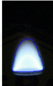
Gambar A1.3 Pengujian 3 warna Api biogas murni
