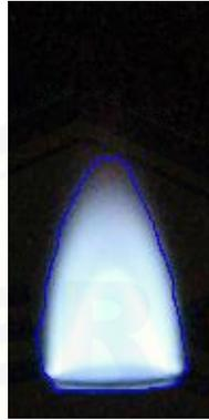
Gambar A1.7 Pengujian 1 warna api BG80Bu20
