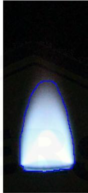
Gambar A1.4 Pengujian 1 warna api BG90Bu10
