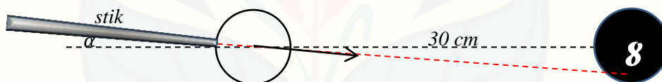
Gambar 3.5 Skema video tumbukan tak sentral pada 5/8 bagian dengan \alpha = 4,1^\circ ( \alpha , merupakan sudut antara arah stik billiards terhadap garis hubung pusat massa kedua bola).
