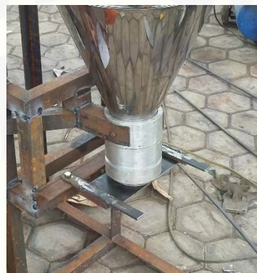
Gambar C.16 Hasil assembly hooper , dudukan hooper , noozle dan lintasan pisau
