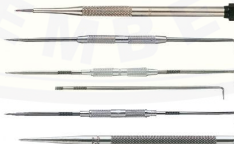
Gambar 2.19 Penggores (Sumber : Pekerjaan Dasar Teknik Otomotif 1, 2013)
