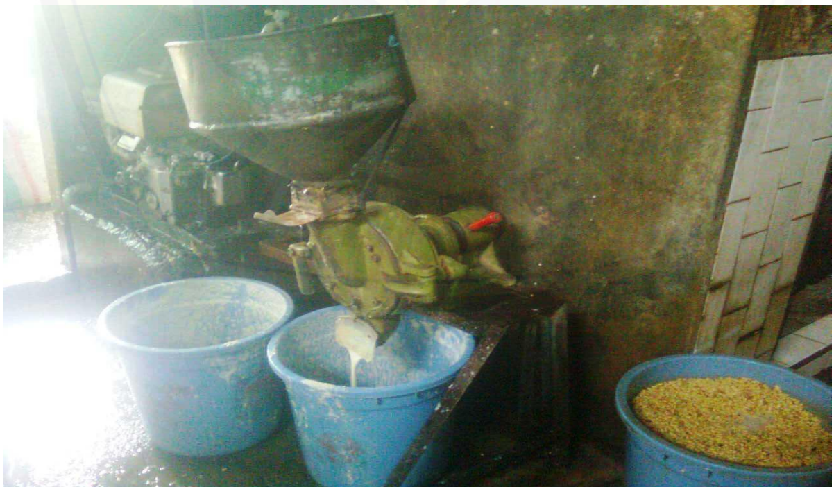
Tahap 2. Kedelai yang telah dikupas digiling di mesin penggiling
