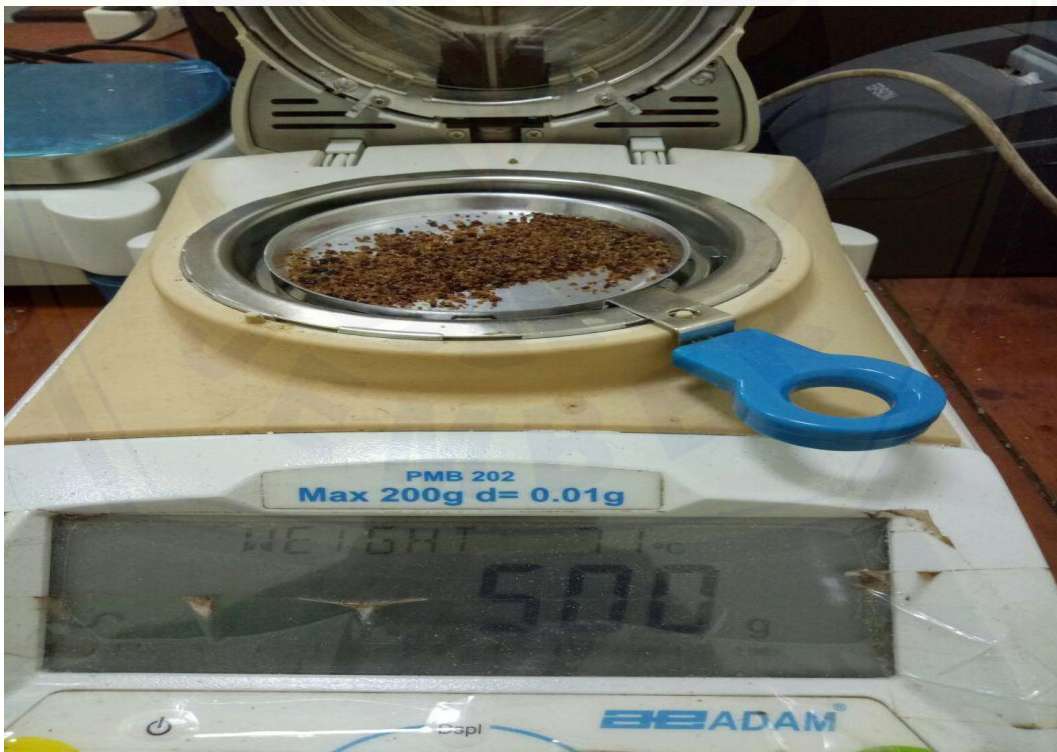
Sejumlah granula dimasukkan ke dalam alat moisture analyzer
