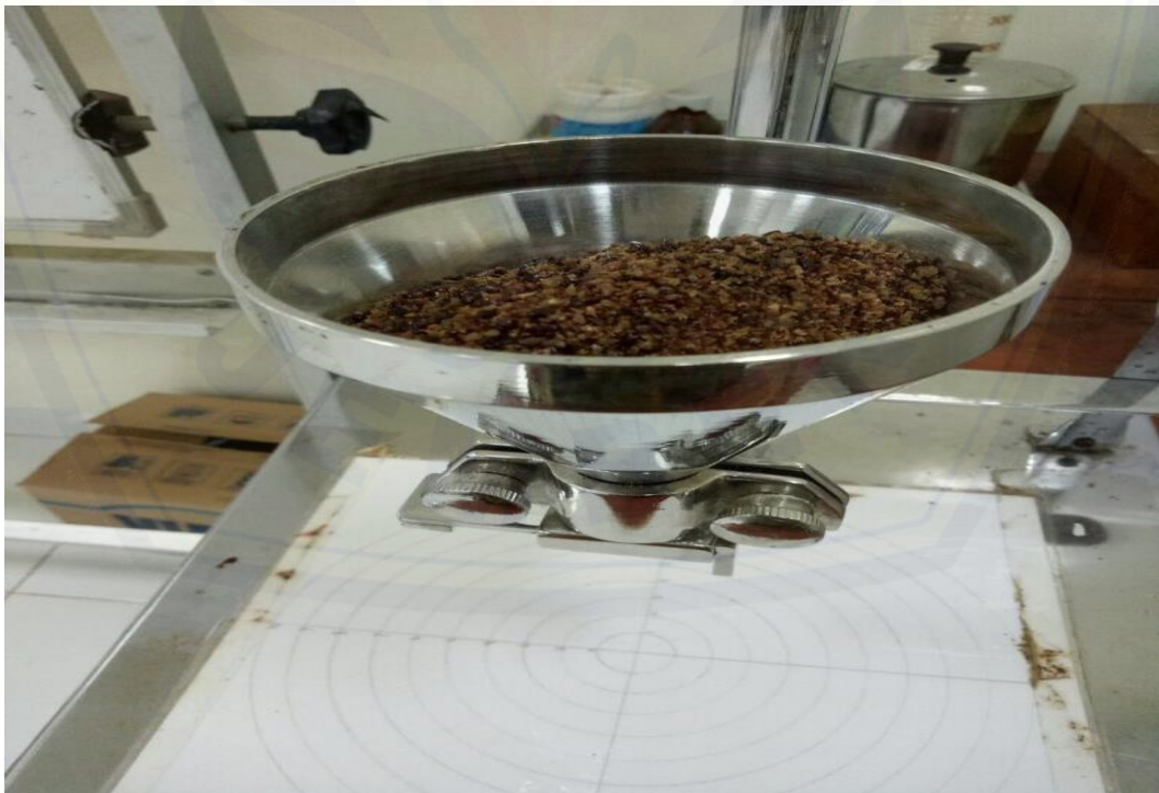
Granula yang sudah ditimbang dimasukkan ke dalam corong
