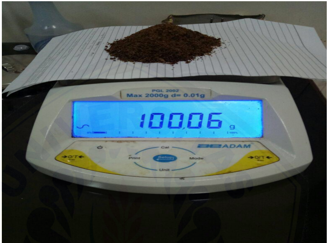
Penimbangan granula seberat 100 gram untuk uji kerapuhan
