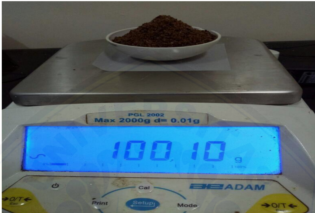
Penimbangan granula seberat 100 gr untuk persiapan uji waktu alir
