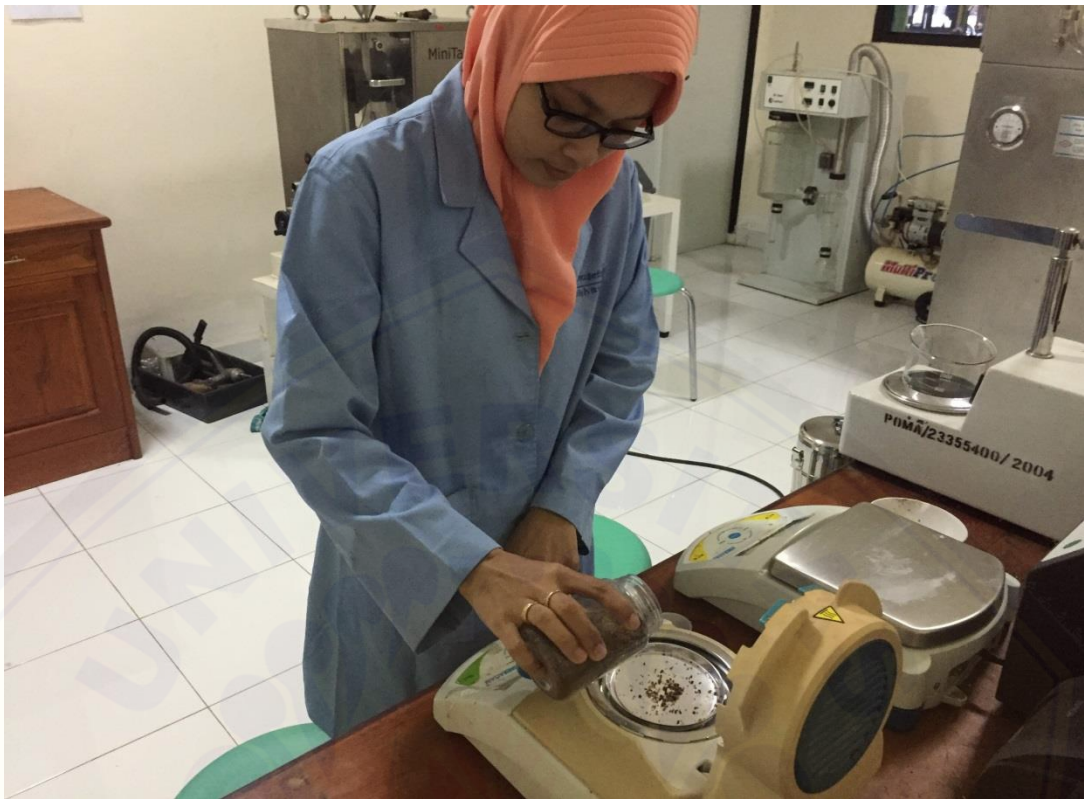
Saat akan melakukan uji kandungan lembab dengan alat moisture analyzer
