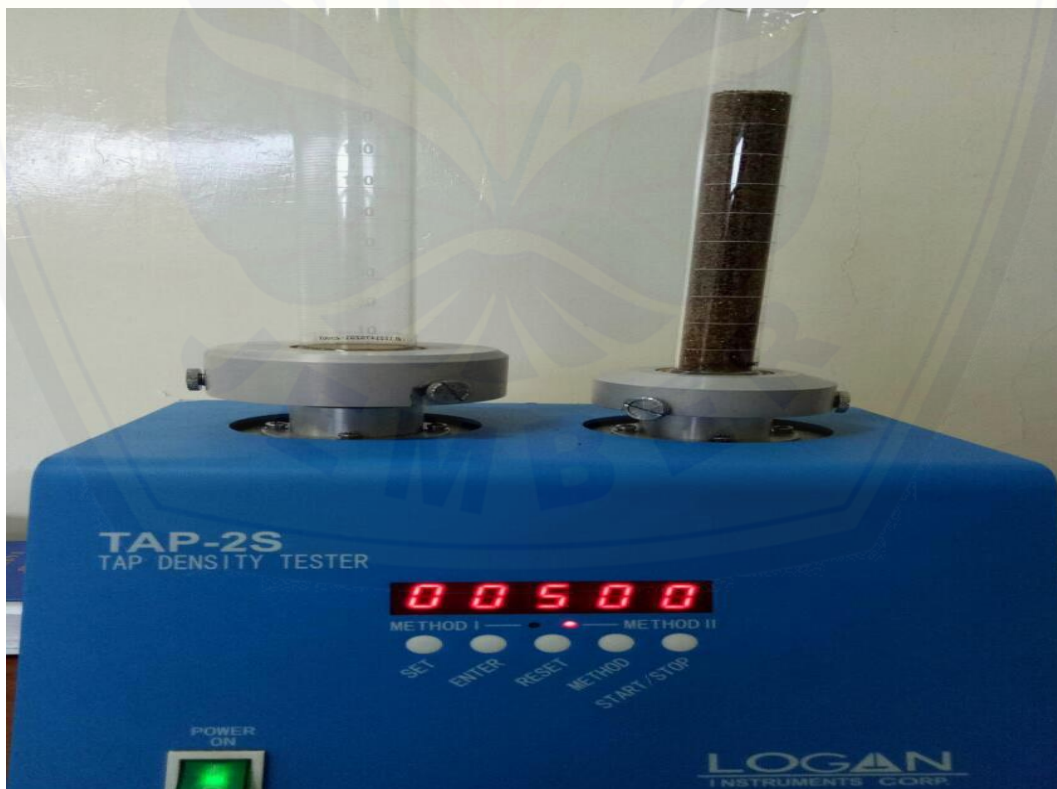
Proses menjalankan uji indeks pengetapan granula
