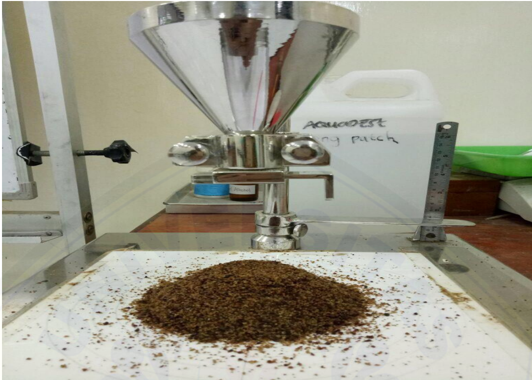
Penutup corong dibuka dan semua granula mengalir ke bawah
