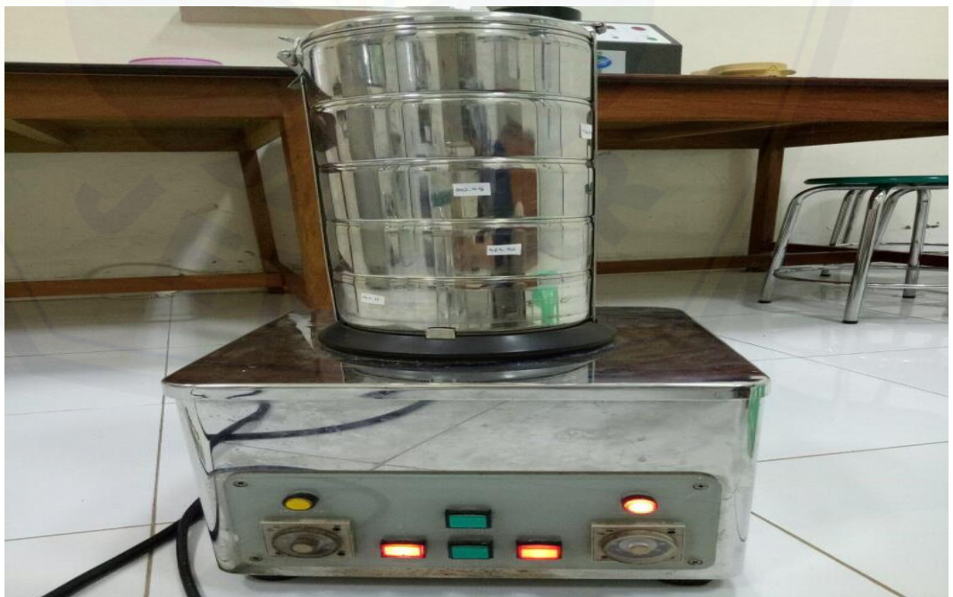
Proses uji kerapuhan granula menggunakan ayakan bertingkat
