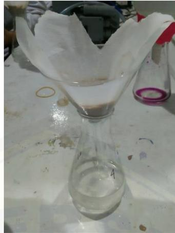
Gambar 3.5 Penyaringan abu ampas tebu dengan kertas saring dan pembilasan menggunakan akuades (Sumber : Koleksi pribadi, 2017).
