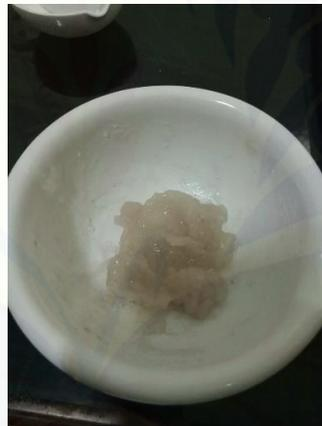
Gambar 3.14 Hasil pencampuran larutan CMC-Na dengan *bioactive glass nanosillica* (Sumber : Koleksi pribadi, 2017).
