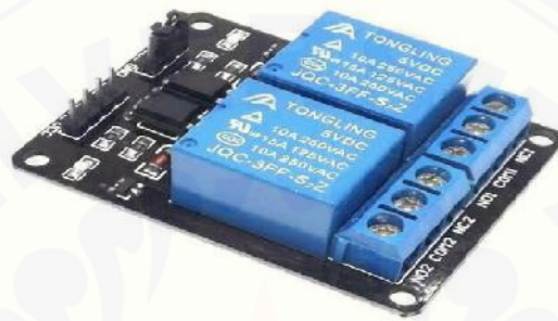
Gambar 2.5 Bentuk fisik modul relay 2 channel (sumber : http://rohmedi.com )
