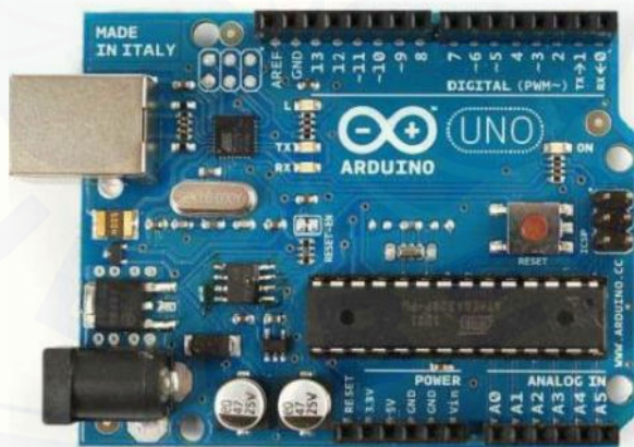
Gambar 2.1. Bentuk Fisik Arduino Uno (sumber : Setiawan, 2014)
