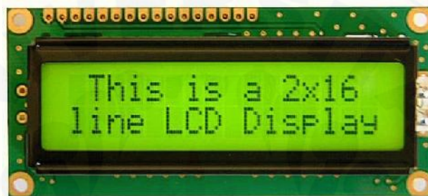
Gambar 2.3 Bagian depan LCD 16 x 2 (sumber : www.leselektronika.com )
