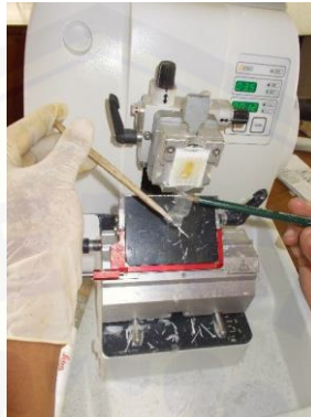
Gambar 3.28 Penyayatan menggunakan mikrotom (Sumber: Koleksi Pribadi)
