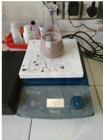
Gambar 3.4 Pengadukan abu ampas tebu dengan larutan HCl (Sumber: Koleksi Pribadi)
