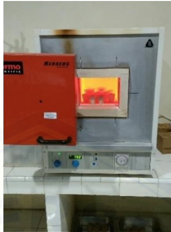
Gambar 3. 11 Pengeringan menggunakan furnace (Sumber: Koleksi Pribadi)
