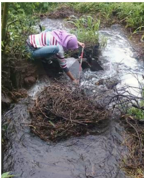
Gambar G.2 Pengukuran kedalaman, debit dan kecepatan aliran
