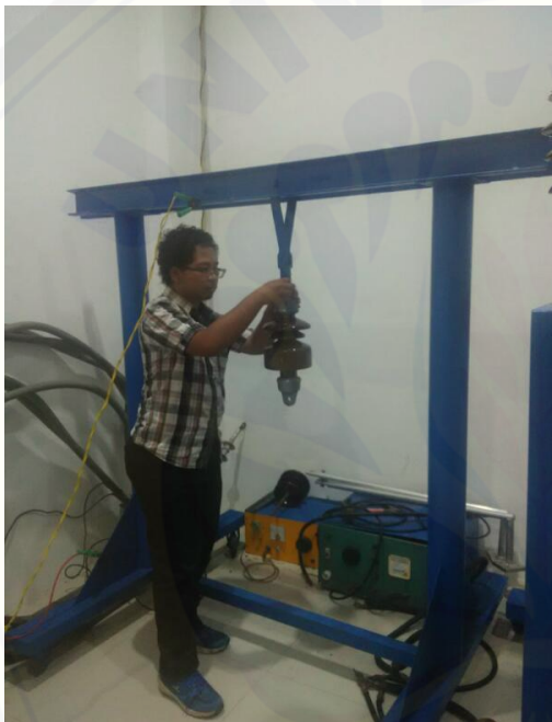
Pemasangan Isolator Tarik
