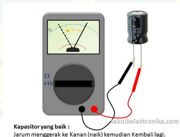
Gambar 2.9 Ilustrasi mengukur kapasitansi pada sebuah kapasitor dengan multimeter analog (Sumber : Kho, 2015. Tersedia : www.teknikelektronika.com )
