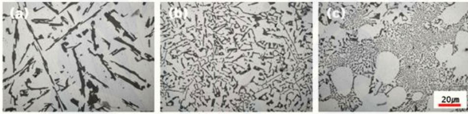
Gambar 2.11 Struktur mikro dan distribusi silikon eutektik dalam paduan dengan penambahan modifier strontium (a) spherical (b) lamellar (c) fine needle (Sumber: Soo Shin, 2011)
