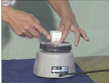
Gambar.2. Menempatkan balok kubus yang telah berisi gips di atas vibrator untuk memastikan tidak ada udara yang terjebak.
