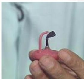
Gambar 26. Rangkaian crusible former, sprue, pola lilin dan ventilasi.
