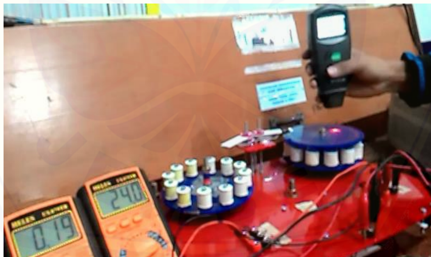
Gambar 6. Pengujian Motor 2 Dengan 12 Kutub Tegangan 24 V Menggunakan Multimeter Dan Tachometer
