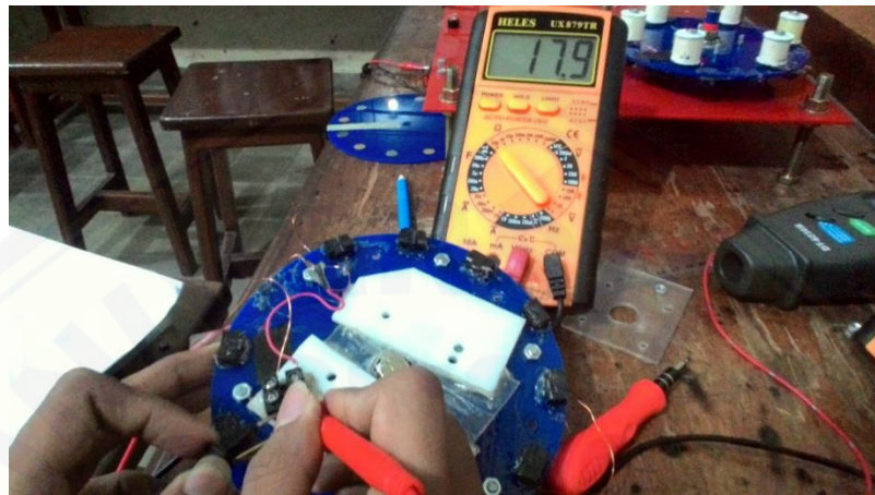
Gambar 1. Pengukuran Resistansi Motor 2 Dengan 6 Kutub Multimeter
