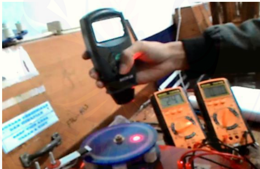
Gambar 8. Pengujian Motor 1 Dengan 6 Kutub Tegangan 24 V Menggunakan Multimeter Dan Tachometer
