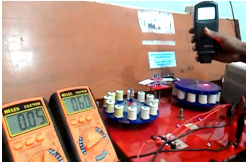
Gambar 5. Pengujian Motor 2 Dengan 12 Kutub Tegangan 6 V Menggunakan Multimeter Dan Tachometer
