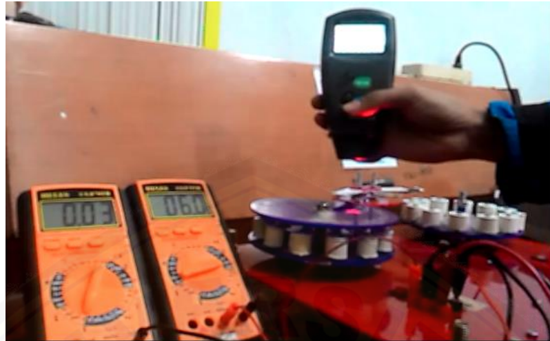
Gambar 3. Pengujian Motor 1 Dengan 12 Kutub Tegangan 6 V Menggunakan Multimeter Dan Tachometer
