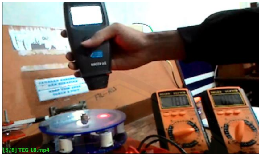
Gambar 7. Pengujian Motor 1 Dengan 6 Kutub Tegangan 18 V Menggunakan Multimeter Dan Tachometer
