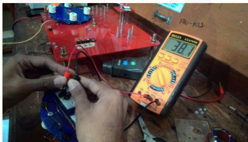
Gambar 2. Pengukuran Resistansi Motor 1 Dengan 6 Kutub Multimeter
