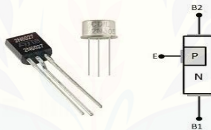
Gambar 2.14 Bentuk Dan Struktur UJT
