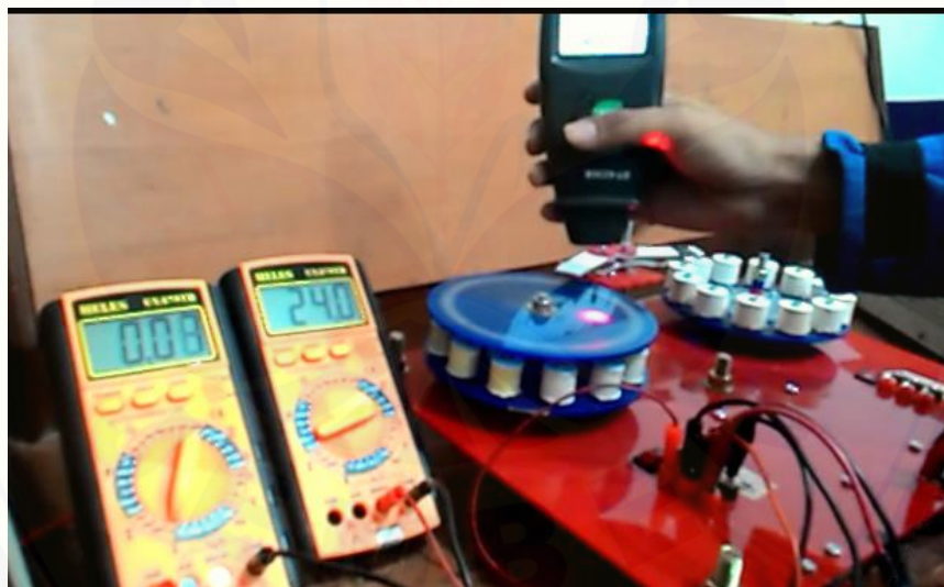
Gambar 4. Pengujian Motor 1 Dengan 12 Kutub Tegangan 24 V Menggunakan Multimeter Dan Tachometer
