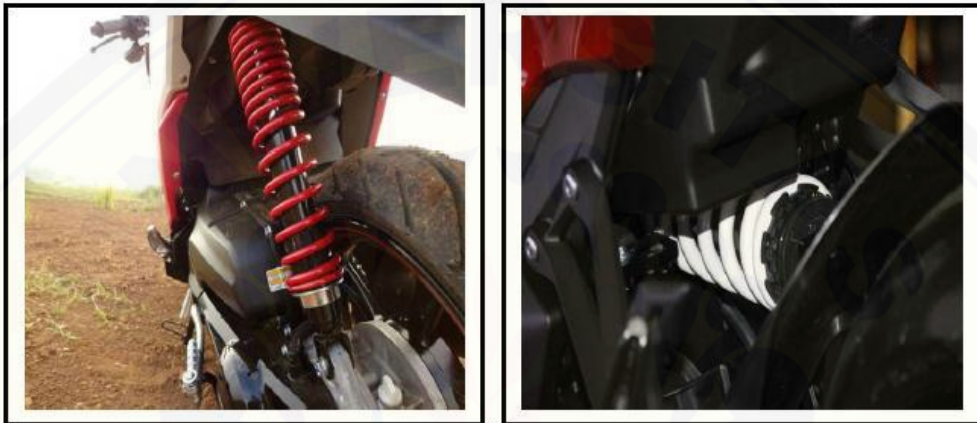
Gambar 1.4 Suspensi pegas pada sepeda motor
