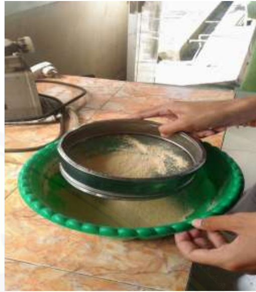
Gambar 6. Pengayakan dengan ayakan 60 mesh
