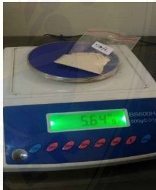
Gambar 8. Menimbang massa adsorben dengan menggunakan timbangan analitik
