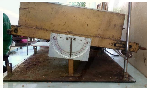
Gambar 1. Modified Columbus Standard Treadmill dengan sudut deklinasi 10°
