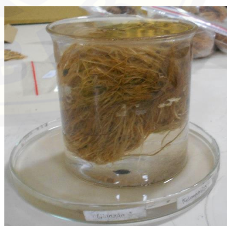
Gambar 5. Pengukuran Volume Akar di Laboratorium
