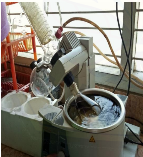
Gambar 3. Proses pemisahan etanol dengan rotary evaporator
