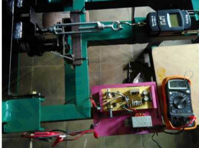
Kalibrasi beban radial menggunakan multimeter sebelum pengujian
