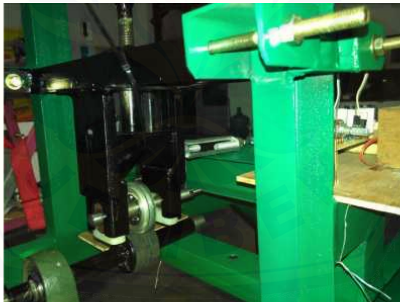
Pemasangan bantalan pada alat uji
