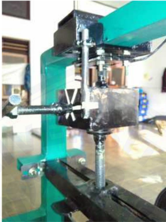
Pengukuran beban radial bantalan menggunakan load cell 50kg
