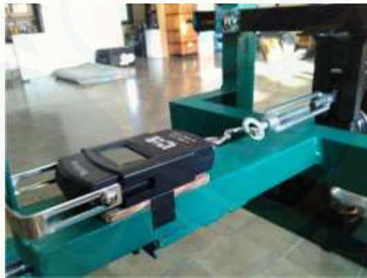
Gambar 3.11 Mekanisme pengatur beban aksial bantalan
