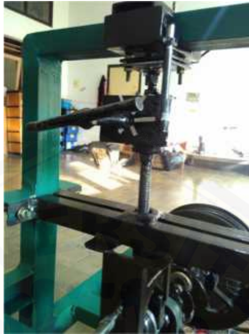
Gambar 3.10 Mekanisme pengatur beban radial bantalan
