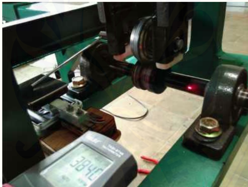
Pengukuran kecepatan putar bantalan
