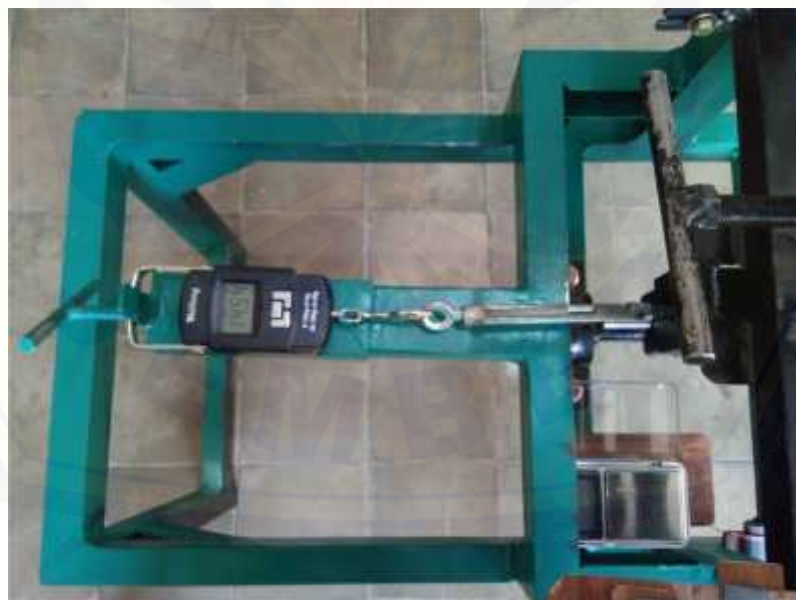
Pengukuran beban aksial bantalan dengan timbangan gantung load cell
