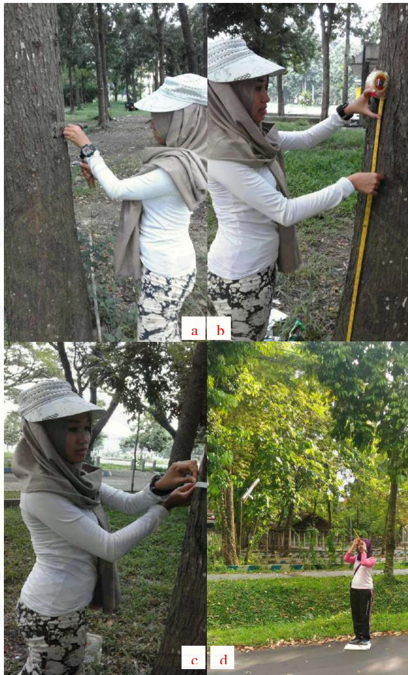
Gambar 1. a.. Penomoran, b. Standard tinggi Pengukuran diameter batang 1,3 m, c. Pengukuran diameter batang, d. Mengukur perkiraan tinggi pohon menggunakan metode clinometer
