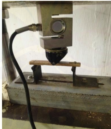
Gambar 3.8 Spesimen menempel pada dudukan bending
