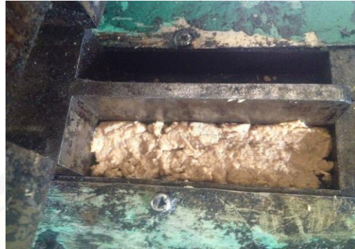
Gambar 3.6 Penuangan adonan pada cetakan
