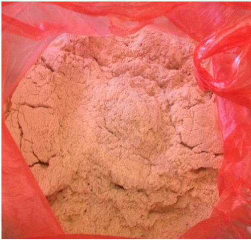
Partikel kayu sengon ukuran 80 mess Perekat urea formaldehida
