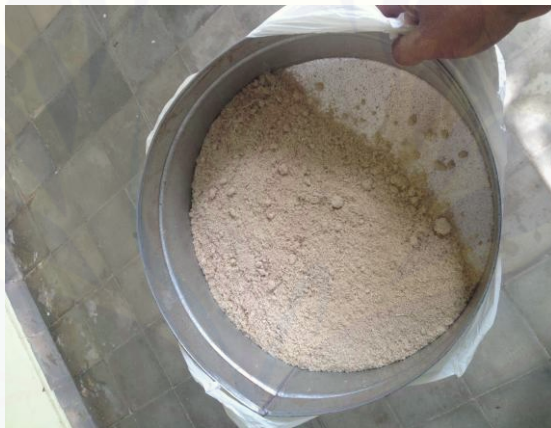
Gambar 3.1 Partikel sengon di ayak dengan ukuran 80 mess
