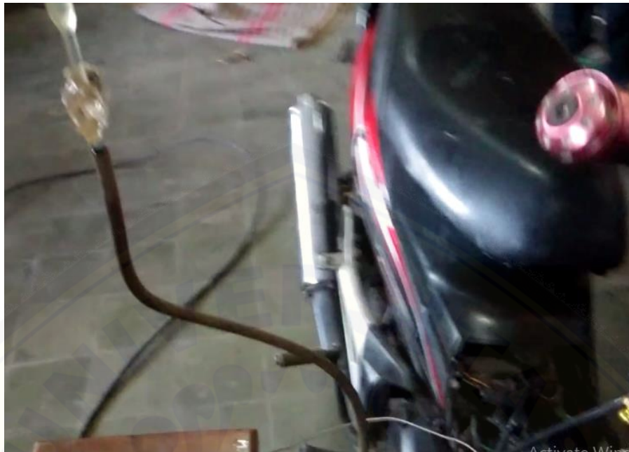
Lampiran D.3 Gambar pengambilan laju konsumsi bahan bakar
