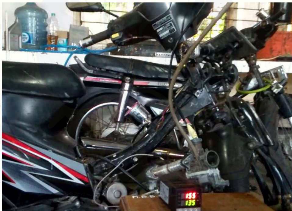
Lampiran D.4 Gambar pengambilan laju konsumsi bahan bakar
