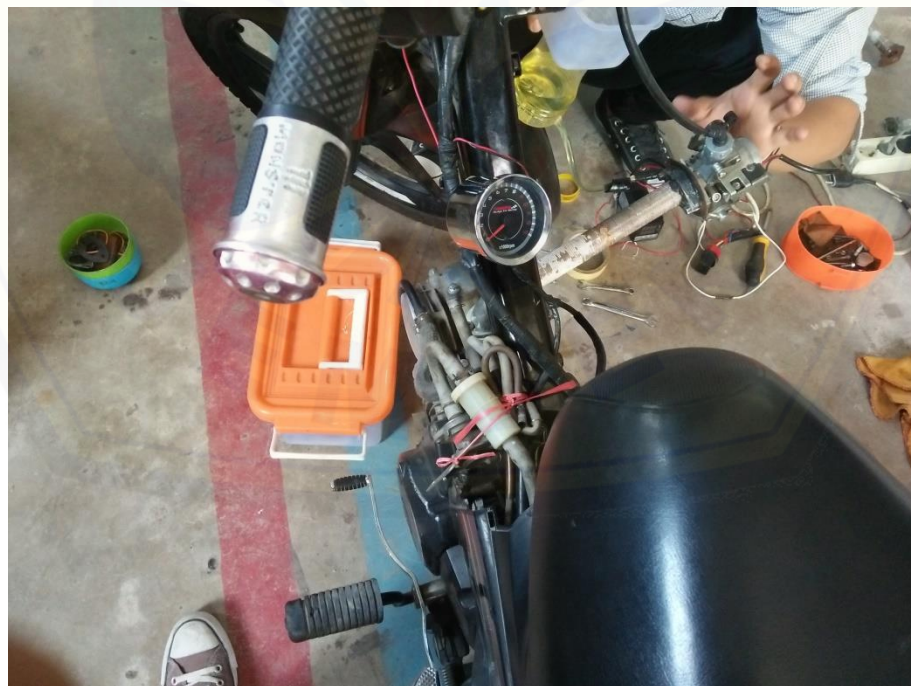
Lampiran D.6 Gambar pengambilan laju konsumsi bahan bakar
