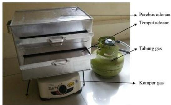
Gambar 3. Alat Perebus Adonan Kerupuk dengan desain khusus
