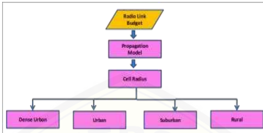
Gambar 2.3 Langkah-langkah menentukan cell radius (Sumber:Ketty Siti Salamah, 2016)
