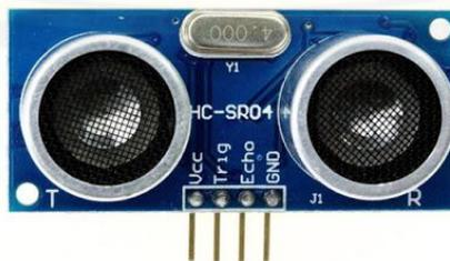
Gambar 2.6 Bentuk Fisik Sensor Ultrasonik HC-SR04
