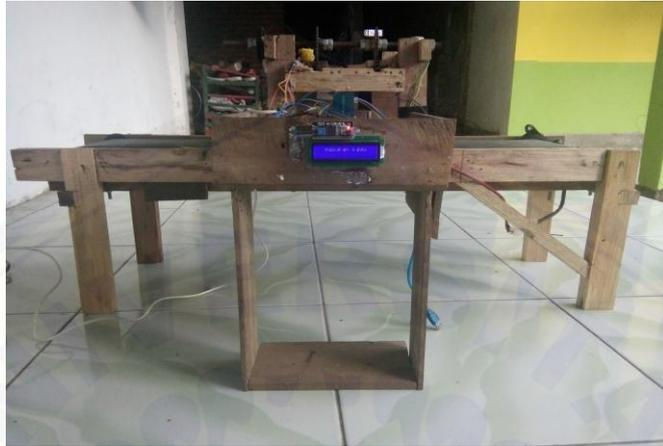
Tampak depan prototipe pengukur diameter kayu
