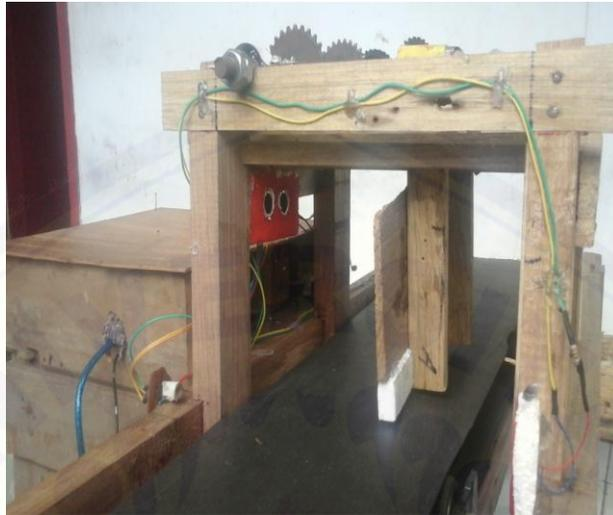
Penempatan posisi sensor Ultrasonik HC-SR04
