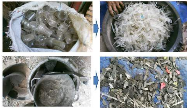
Gambar 5.3. Chip plastik hasil hancuran mesin penghancur plastik
