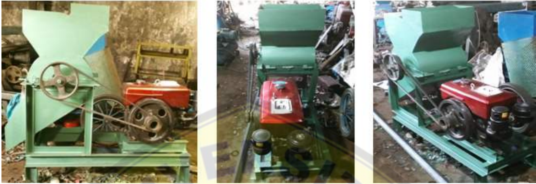
Gambar 1. Mesin penghancur sampah plastik hasil kegiatan
