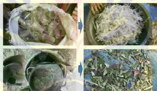
Gambar 31. Chip plastik hasil hancuran mesin penghancur plastik
