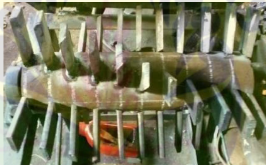
Gambar 2. Pisau mesin penghancur sampah plastik hasil kegiatan
