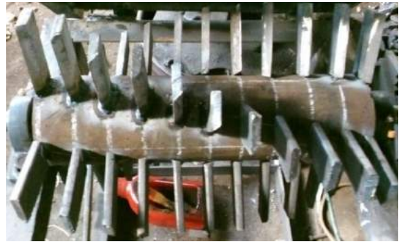
Gambar 2. Pisau mesin penghancur sampah plastik hasil kegiatan
