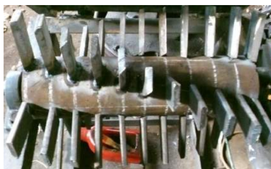
Gambar 5.2. Pisau mesin penghancur sampah plastik hasil kegiatan
