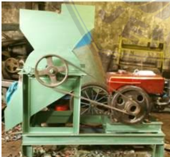
Gambar 1. Mesin penghancur sampah plastik hasil kegiatan
