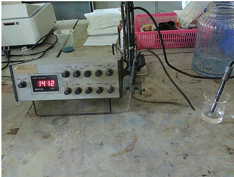
Gambar E.7 Pengkalibrasian Conductivity Meter Sebelum Mengukur Nilai DHL Susu Fermentasi
