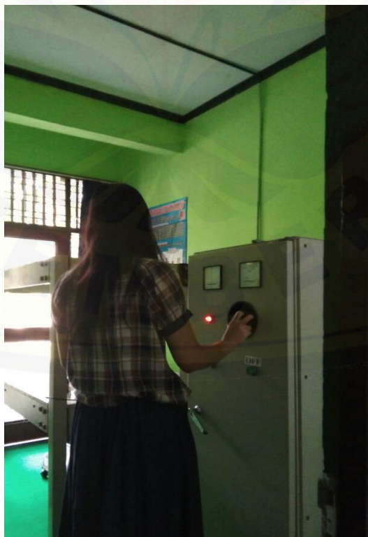
Gambar E.2 Pengaturan Intensitas Medan Magnet ELF Sebelum Proses Pemaparan
