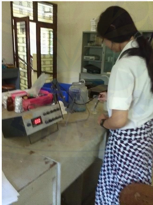
Gambar E.8 Pengukuran DHL Susu Fermentasi Menggunakan Alat Conductivity Meter
