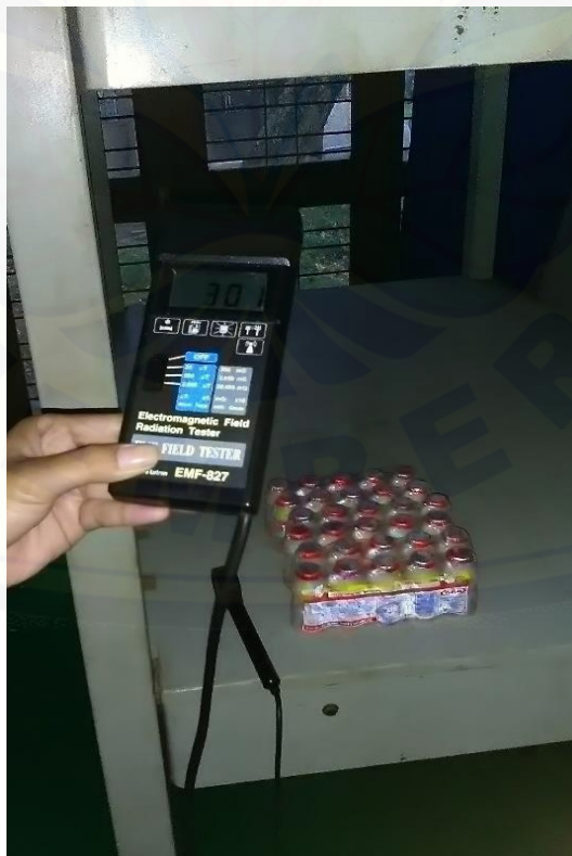
Gambar E.4 Pengaturan Besar Intensitas Medan Magnet ELF Menggunakan Alat EMF Tester
