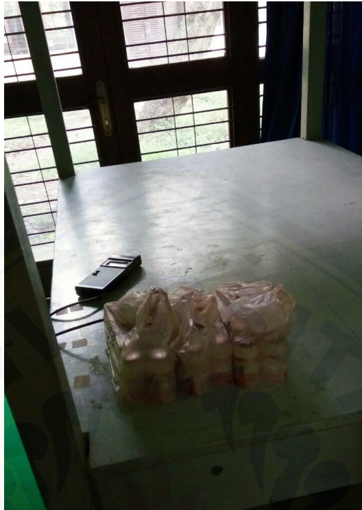
Gambar E.3 Proses Pemaparan Sampel Susu Fermentasi dengan Menggunakan Alat Penghasil Medan Magnet ELF
